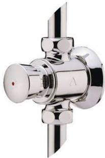
Pression d'utilisation recommandée : 1 à 5 bars. Débit : 8 L/mn à 3 bars par limiteur de débit incorporé. Réglage de débit par bague fileté. Dispositif anti-coup de bélier. Durée d'écoulement : 30 secondes (-10 / +5 secondes). Alimentation hydraulique : Mâle G 3/4" (20x27) en eau froide ou pré-mitigée.
