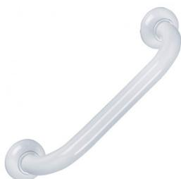
Tube aluminium Ø 30 mm, revêtement époxy blanc. Embases et cache-fixations en résine de synthèse. Fixations invisibles. Avancement 100 mm. Charge admissible 150 kg. Certification TÜV CE.
