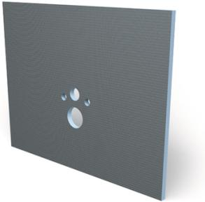
L'I-Board de wedi est constitué d'une mousse dure de polystyrène extrudé, qui est armé des deux cotés avec un tissu en fibres de verre résistant aux alcalis et qui est recouvert d'un mortier plastifié.
