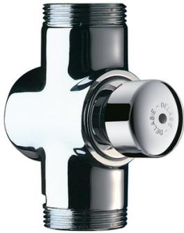
Robinet chasse tempo mâle-mâle 1/1/4 Robinet temporisé de chasse directe à bouton poussoir à poser en applique : Temporisation 7 sec. Protection antisiphonique. Corps et bouton en laiton massif chromé. Mécanisme antichoc. Alimentation en ligne M1\*1/4. Hauteur 110 mm.
