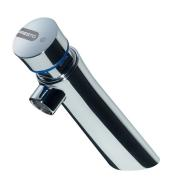
Pression d'utilisation recommandée : 1 à 5 bars. Débit : 3 l/mn à 3 bars, réglage 4 positions, dispositif anti-coup de bélier. Durée d'écoulement : 15 secondes ± 5 secondes. Alimentation hydraulique : Mâle G 1/2 (15x21).
