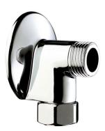
Raccord applique en laiton chromé. Ecrou collet battu Ø 14. Fixation par patte à vis. M1/2" - M3/4". Livré par 2 pièces."
