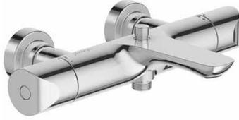
Mitigeur thermostatique bain-douche. Économie d'eau : Un débit limité à 13l/mn. Confort : Une régulation ultra-rapide pour assurer une eau à température constante et une butée de température à 37°C. Sécurité : Un corps tiède pour éviter tous risques de brûlures. Et un blocage automatique de l'arrivée d'eau au-delà-de 50°C en cas de coupure d'eau froide.
