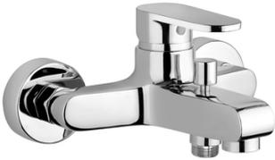
Mitigeur bain douche mural. Longueur de bec : 113 mm. Manette en métal. Cartouche C2 diamètre 35 mm. Limiteur de débit : Economie d'eau grâce à la butée à 50% du débit. Clapet antipollution sur départ douche. Raccords excentriques et rosaces laiton Ø 60 mm. Mousseur anticalcaire. Ouverture avec butée sensitive à 50% du Débit. Clapet antipollution sur départ douche.
