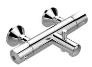
Elément thermostatique à cire avec grille anti tartre. Tête 1/2' à disque céramique. Croisillon de température avec butée de sécurité à  $40^{\circ}$ C débrayable.
