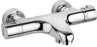
Anticalcaire avec filtres. Cartouche thermostatique C3. Limiteur de température anti-brûlure réglable. Raccords excentriques et rosaces laiton Ø 60 mm.
