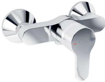
Sortie de douche ½" par le dessous. Clapet anti-retour intégré. Cartouche Ø 40 mm à 2 disques céramique.
