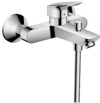
Mitigeur bain/douche C2 avec cartouche à 2 vitesses chromé. 2 sorties = 2 fonctions. Longueur : 194 mm. Entraxe : 150 mm +/- 12 mm. Type de jet du mitigeur : jet normal. Débit maximal sous 3 bars de pression : 22 l/min. Cartouche céramique à 2 vitesses. Limiteur de température réglable. Inverseur avec réinitialisation automatique. Clapet anti-retour intégré. Avec silencieux. Convient au chauffe-eau instantané. Type de raccordement : raccords S. E3/1, C2, A2, U3.
