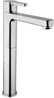
Vidage clic-clac laiton. Cartouche Ø 35 mm C3. 2 flexibles de raccordement inox 500 mm. Mousseur anticalcaire. Hauteur sous bec : 252 mm. Longueur de bec : 170.5 mm. Hauteur totale 310 mm.
