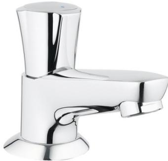
Hauteur totale : 93 mm. Saillie : 80 mm. Hauteur sous bec : 39 mm. Marquage bleu. Tête Carbodur. Bec coulé avec mousseur. Ecroû de raccord 1/2 à taraudage 10,5 mm.
