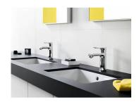
Le mitigeur de lavabo Metris bec fixe avec cartouche céramique M2. ComfortZone 110. Longueur 116mm. Débit: 5 litres/min. Limiteur de température réglable. Fourni avec garniture de vidage G 1-1/4. Convient au chauffe-eau instantané.
