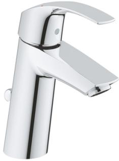
Mitigeur lavabo chromé, monotrou. Levier de commande métallique. Cartouche en céramique 28 mm. Avec limiteur de température. Economie d'eau mousseur 5 l/min. Installation rapide. Tirette et garniture de vidage 1-1/4". Flexibles de raccordement souples.
