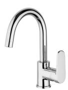
Mitigeur lavabo bec haut. Cartouche Ø 35 mm C2. 2 flexibles de raccordement inox 370 mm. Mousseur anticalcaire. Hauteur sous bec : 160 mm. Longueur de bec : 169 mm. Hauteur totale 270 mm. Sans vidage.
