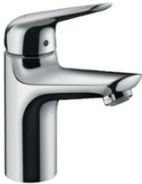
Avec tirette et vidage. ComfortZone 100. Bec fixe. Longueur 118 mm. Jet normal. Débit : 5 l/min. Cartouche céramique M2. Limiteur de température réglable. Garniture de vidage 1/4". Convient au chauffe-eau instantané. ACS 17 ACC LY 602.
