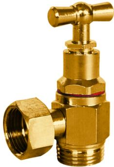
Robinet à potence en laiton chromé à équerre mâle / femelle 3/8" avec presse-étoupe en PTFE et écrou tournant pour fluides courants
