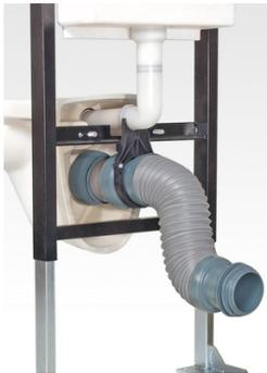
Raccordement sur céramique  $\varnothing$  102 mm +/- 5 mm, tout collier de bâti-support et canalisation  $\varnothing$  100 et 110 mm. Monter le manchon supérieur de la pipe dans le collier du bâti-support et emboîter le manchon inférieur dans l'attente d'évacuation.
