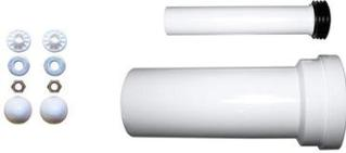
Manchon d'évacuation droit longueur 285 mm, diamètre 100 mm, en PVC, joint en EPDM. Manchon d'alimentation droit longueur 239 mm, diamètre 45 mm, en PEHD, avec butée pour joint, joint à lèvres en élastomère pour Ø 55 mm. Kit de fixation cuvette rapide avec écrous et caches.
