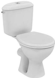
Cuvette sortie horizontale. Abattant thermodur. Fixation par le dessous. Charnières inox. Réservoir réversible. Alimentation latérale, silencieux. Soupape à double chasse 3/6L, ensemble de fixations.
