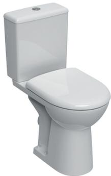
Abattant fermeture ralentie et déclinable. WC au sol. Rinçage double touche. Cuvette Rimfree sans bride. Sortie horizontale. Réservoir réversible, pour alimentation latérale. Type 1, volume total 6 l, selon EN 997. Hauteur d'assise surélevé 46 cm. Abattant WC en duroplast. Couvercle d'abattant recouvrant.
