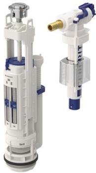
Mécanisme économiseur d'eau double chasse : 3/4L ou 6/9L. Adaptable à tout type de réservoir. Hauteur de la cloche auto-ajustable. Tube de trop-plein réglable en hauteur. Kit d'adaptation pour réservoir avec trou du couvercle de 50 mm. Alimentation latérale, 12 x 17 mamelon en laiton chromé brillant.
