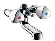
Bec fixe à brise-jet. Croisillons DELTA chromés. Pour "échange-standard". Corps en laiton chromé. M1/2", entraxe 110 mm. S?adapte à l?entraxe existant. Il permet le remplacement d?un ancien mélangeur par échange standard, sans modification de l?installation.
