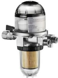
Séparateur d'air intégré. Pour conduite d'aspir. et syst. simple conduite. Avec réalim. par récupérateur du retour. G3/8 Fx G3/8 M, Siku, 25-40 m.
