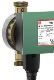
Bouclage ECS. Pompe de circulation à rotor noyé avec raccord fileté et moteur synchrone auto-protégé. Modèle A : avec vanne à boisseau sphérique et clapet anti-retour. Modèle T : avec vanne à boisseau sphérique, clapet antiretour, horloge, thermostat et détection de la désinfection thermique.
