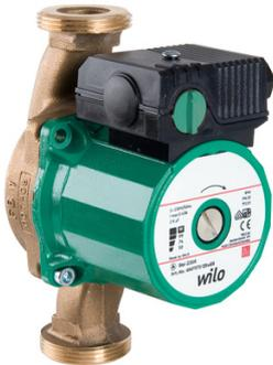
Pompe de circulation d'eau chaude sanitaire, convient seulement pour l'eau potable. Pompe à rotor noyé à vitesse constante pour installation en ligne. Moteur auto-protégé. Corps de pompe en laiton rouge, roue en plastique renforcé de fibre de verre, arbre en céramique avec palier lisse en carbone imprégné de résine. Certifié ACS.
