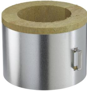
La coquille isolante placée autour du conduit, permet d'assurer la rupture du pont thermique au passage des conduits en plafond
