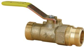
Pression maximale d'utilisation : 500 mbar. Robinet double mâle à Joint Plat Gaz. Classe de température : - 20°C / + 60°C. Certifié NF ROB GAZ. Conforme NF EN 331.
