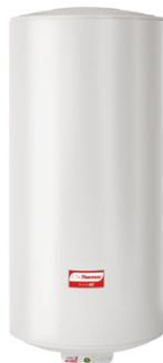
Chauffe-eau blindé équipé de : une résistance «thermoplongeur» : en contact direct avec l'eau et exposée au calcaire, en cas de remplacement, obligation de vidanger le chauffe-eau. Protection anticorrosion : l'anode en magnésium se dissout dans le temps et nécessite donc un contrôle de l'usure tous les 2 ans et un remplacement si nécessaire. Horizontaux avec raccordement dessous.
