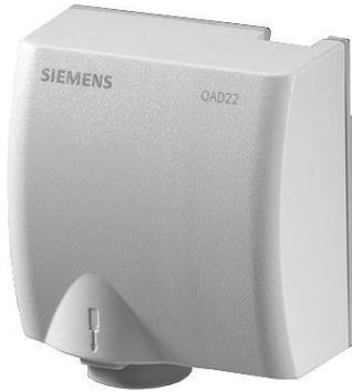
Sonde de température de départ d'applique. Ni 1000 ohms/0°C. Fixation de tendeur pour tuyaux DN15...140 mm fournie.
