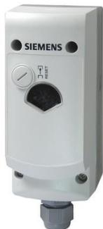
Réglage intérieur à réarmement manuel. Montage en applique. Plage de réglage 45° à 60° C. Capillaire longueur de 700 mm. Plage de tension 24 à 250 V. Pour plancher chauffant. Pouvoir de coupure : 0,1 ?10(2,5)/0,5 A.
