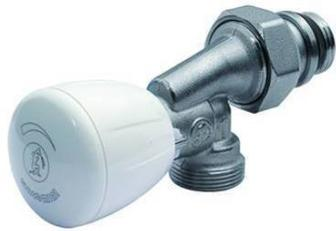
Série "FER". Double réglage micrométrique. Douille auto-étanche. Température : 5-110 °C. Pression max de service : 16 bars. Composition : corps, écrou et douille en laiton, volant en ABS. À compléter avec adaptateur R178 pour tube cuivre, R179 pour tube plastique, ou R175 AM pour les tubes multicouches. Livré avec capuchon de protection.
