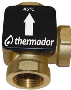
La vanne assure un recyclage vers le foyer tant que la température de consigne n'est pas atteinte. Température maxi. De fonctionnement : 110°C. Pression maxi. de fonctionnement : 6 bar. Corps de la vanne : laiton FFF 1" ou 1"1/4. Capsule thermostatique intégrée tarages 45°C, 61°C ou 72°C.
