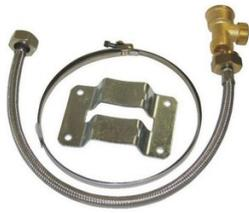
Ce kit de branchement ZKVEX pour vexbal - de 5L à 12L est l'élément indispensable pour le raccordement des vases d'expansion de réseau eau chaude sanitaire. Support mural avec un ruban Serflex. T MMF 3/4". Flexible de 50 cm FF.
