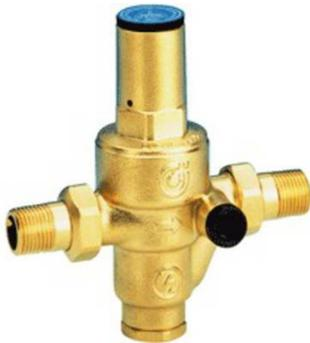
Réducteur de pression 2" MM avec filtre incorporé et cartouche remplaçable. Pression amont maxi : 25 bar. Pression aval réglable: 0,5 à 6 bar. Pré taré à 3 bar. Température maxi : 80°C. Sans manomètre, avec raccords démontables MM. PN25.
