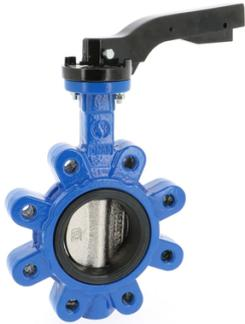
Robinet à papillon à oreilles taraudées, corps fonte GL avec papillon fonte GS et manchette EPDM, peinture époxy, montage entre brides, pour eau chaude et eau froide.
