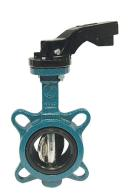
Robinet à papillon à oreilles de centrage, avec corps fonte GL, papillon en fonte GS et manchette EPDM, platine ISO 5211, double étanchéité PTFE, pour eau froide et eau chaude.
