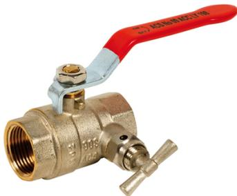
Passage intégral. Presse étoupe en PTFE (120°C). Laiton titré conforme Norme Européenne EN12165. Manette plate. Traçabilité (logo-date de fabrication). ACS et conforme 4MS.
