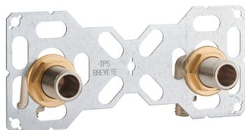
Platine qui se fixe avec les 5 chevilles qui sont à retirer laissant ainsi la surface plane pour faciliter la pose du carrelage. Les 2 coudes se clipsent sur la platine. Entraxe 150 mm
