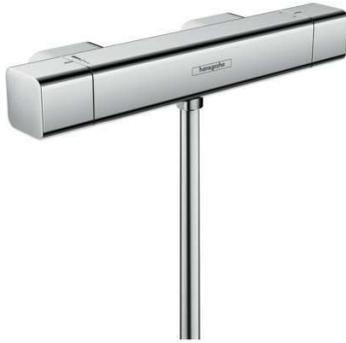
Mitigeur thermostatique douche. Entraxe: 150 mm  $\pm$  12 mm. Bouton EcoStop. Butée de confort à 40° C. Clapet anti-retour intégré. Avec silencieux. Convient au chauffe-eau instantané. Poignées: métallique. Raccordement en S. Filtre inclus.
