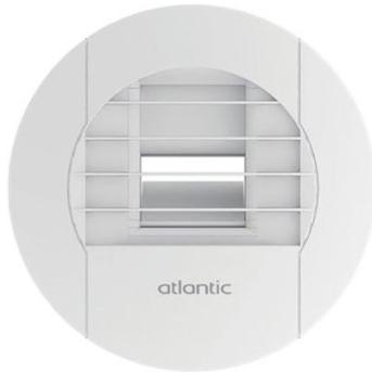
Destinée aux WC. Capable de moduler le débit en fonction de l'humidité ambiante. Possibilité d'un montage mural ou sur plafond. Débit complémentaire temporisé (30 min). Alimentation à piles. Activation du débit complémentaire par détection de mouvement. Destination : Résidentiel - Petit tertiaire. Inclus dans le kit : 1x Bouche WC 80 mm, 1x Manchon court, 1x Piquage twist&go, 1x Collier de serrage.
