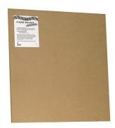
Plaque à base de fibres de laine minérale pour l?isolation thermique et la protection au feu jusqu?à 1100°C. Isolation d?un mur par rapport à un générateur de chaleur. Garnissage interne de fours, foyers et hottes. Classement de réaction au feu : M0 (PV CSTB n° RA08-0020B.
