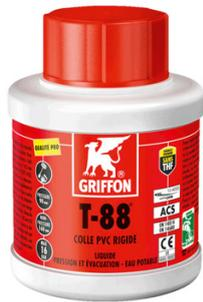
Colle PVC rigide à prise rapide, liquide, sans THF. Pour coller les tuyaux, manchons et raccords à ajustage serré dans des installations sous pression et d'évacuation. Avec pinceau-goupillon spécial pour une utilisation rapide et facile. Convient pour des diamètres jusqu'à 160 mm (pression ? 90 mm). Max. 16 bar (PN 16). Tolérance maximale 0,3 mm jeu / 0,2 mm serrage. Convient notamment pour toutes les installations conformément aux normes EN 1329, 1452, 1453 et 1455.
