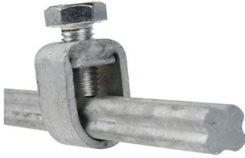
Piquets de terre galvanisés cruciforme : Galvanisation épaisse, en moyenne ? 85?m, pointe de fonçage biseauté, bride en acier galvanisée capacité 6 à 35mm<sup>2</sup> (couple de serrage compris entre 4 et 10 Nm)
