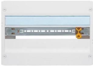
Coffrets 13 et 18 modules par rangée. Peuvent s'installer sur goulotte GTL ou sur mur. Rails inclinables et extractibles. Espace sous rails : 40 mm. Entraxe entre rails : 125 mm.
