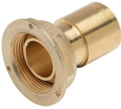
Pression maximale d'utilisation : 500 mbar. Écrou prisonnier tournant femelle plombable et douille à Joint Plat Compteur à brasier sur tube cuivre ou sortie acier. Livré avec 1 joint. Version disponible avec oreille de fixation.
