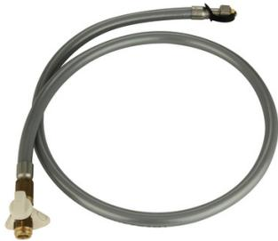
Pression maximale d'utilisation : 37 mbar. Robinet avec obturateur automatique intégré. Tuyau flexible inox annelé renforcé par une tresse en fil d'acier inoxydable, équipé d'1 joint. Entrée : mâle G 1/2". Sortie : écrou prisonnier tournant femelle G 1/2" avec bouchon. Classe de température : - 5°C / + 60°C.
