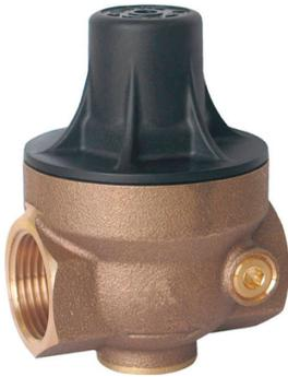
Version chapeau composite , Corps bronze et siège inox, 2 prises manométriques permettant la purge. Réglage simple de la pression avale, Préréglé d'usine à 3 bar. Pression maxi 25 bar. Température maxi : 80°C. Montages toutes positions. Norme ACS. Normalisation NF EN1567. Garantie 5 ans.
